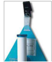
Figure 5 : Exemple de tube à diffusion passive
