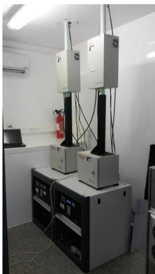
Les mesures automatiques des particules en suspension PM10 et PM2.5 sont réalisées à l'aide de deux TEOM FDMS.
