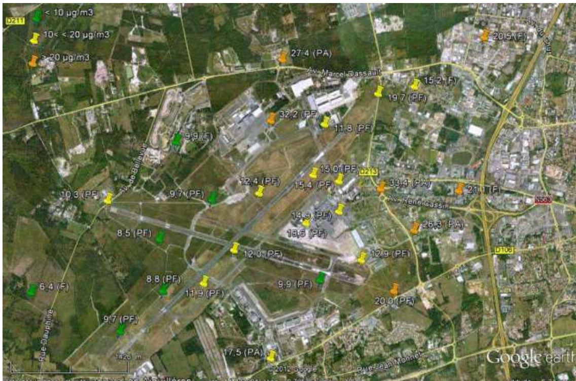
Figure 10 : Concentrations moyennes en dioxyde d'azote en 2011 sur et à proximité de l'aéroport de Bordeaux-mérignac
