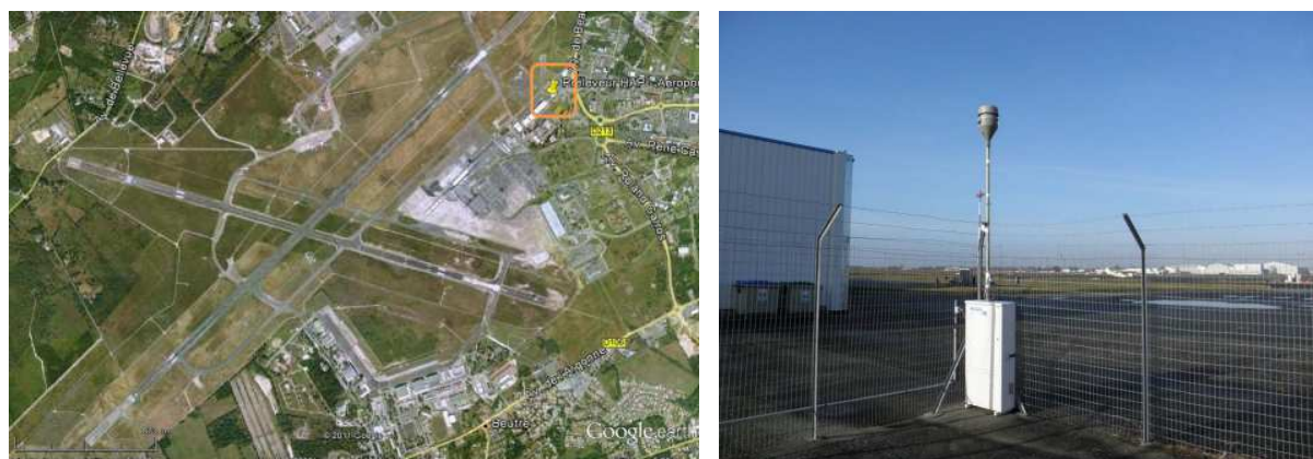
Figure 14 : implantation du préleveur DA80 sur l'aéroport de Bordeaux-Mérignac
