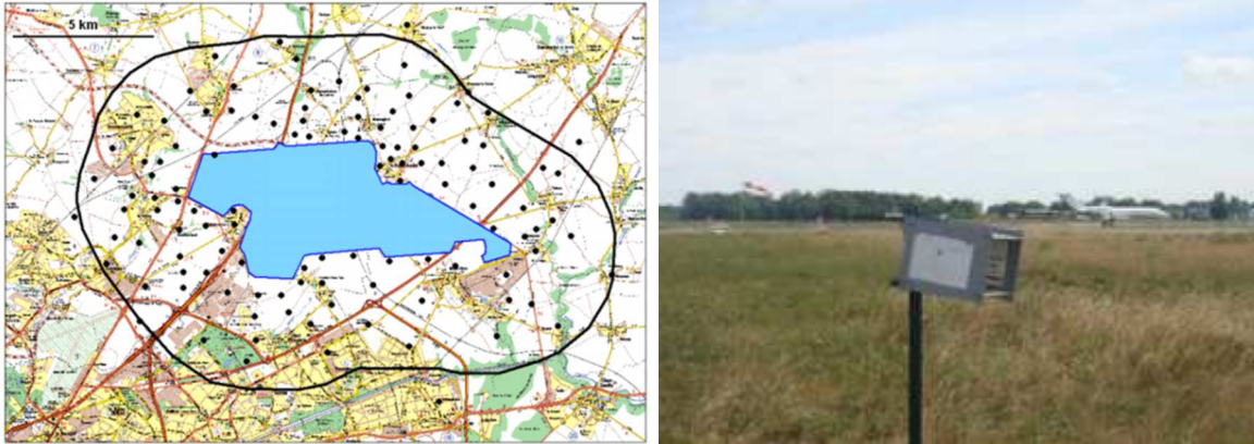
Figure 1 : Périmètre d'étude et emplacement des sites de mesure par échantillonnage passif (points noirs) aux alentours de la plateforme aéroportuaire de Paris - Charles de Gaulle (en bleue) à gauche et abri de mesure par échantillonnage passif sur l'aéroport de Bordeaux Mérignac à droite
