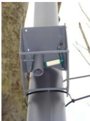
Figure 6 : Echantillonneurs passifs placés sous leur abri de protection
