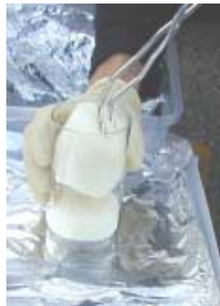
Figure 16 : récupération des supports de conditionnement filtre et mousses du DA80 après prélèvement, ces échantillons sont ensuite transportés dans un réfrigérateur portatif
