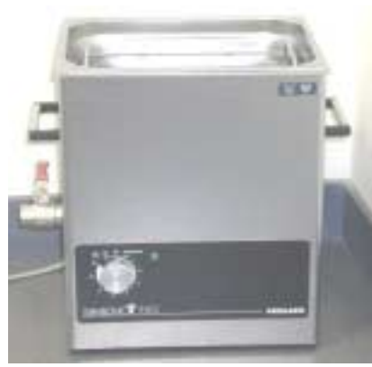
Figure 15 : divers équipements utilisés pour le conditionnement du matériel destiné aux mesures de pesticides (four à moufle à gauche, cuve à ultrasons au milieu et dessiccateur à droite)
