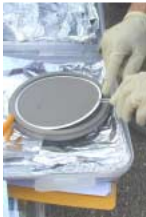
Figure 16 : récupération des supports de conditionnement filtre et mousses du DA80 après prélèvement, ces échantillons sont ensuite transportés dans un réfrigérateur portatif
