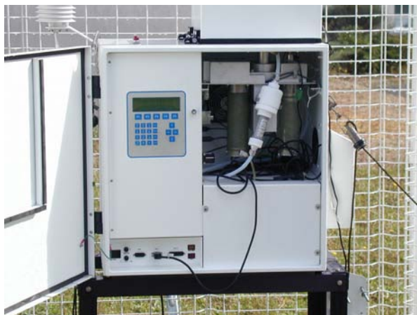
Figure 2: Préleveur bas-volume Partisol 2000
