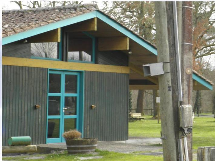
*Figure 5 :Echantillonneurs passifs placés sous leurabri de protection - Origne*
