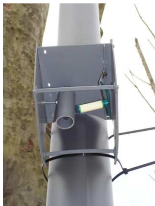
Figure 19 : Echantillonneurs passifs placés sous leur abri de protection
