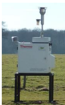
Figure 6 : Préleveur dynamique à bas débit de métaux lourds en situation
