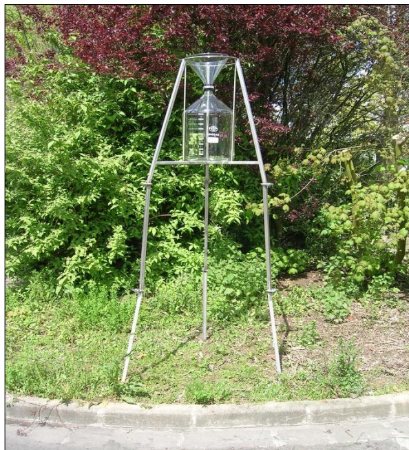
Figure 2 : Jauge OWEN en situation (jauge verre sur illustration)
