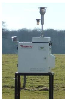
Figure 4 : Préleveur dynamique à bas débit de métaux lourds en situation
