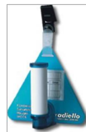
Figure 3 : Exemple de tube à diffusion passive
