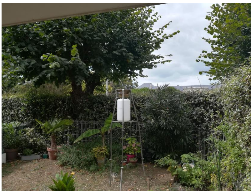
Figure 3 : Photographie d'une jauge Owen au niveau du site de Colombier 7
