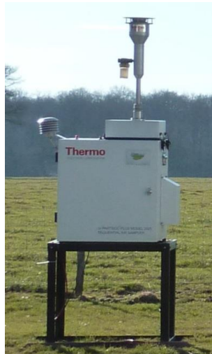
Figure 4 : Préleveur dynamique bas débit
