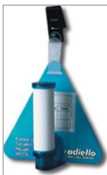
Figure 3 : Tube à diffusion passive
