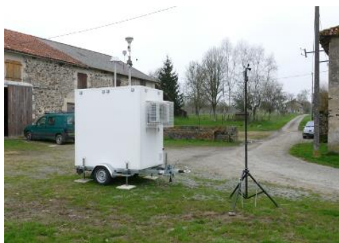
Figure 5 : Moyen mobile contenant les analyseurs automatiques
