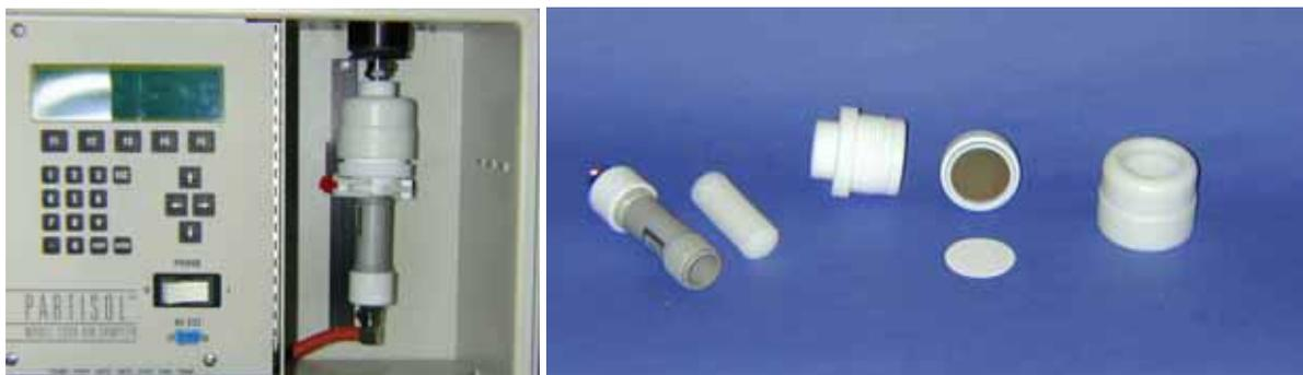
Figure 2 : Module d'échantillonnage assemblé dans le préleveur et ses différents éléments (photo INERIS – LCSQA)
