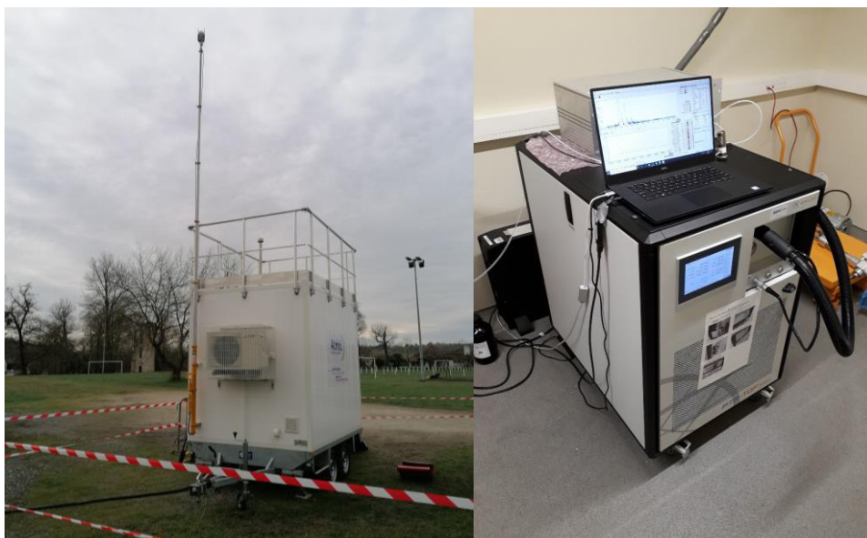
Figure 2 : Photos de la remorque installée à Maslacq et du PTR-ToFMS
