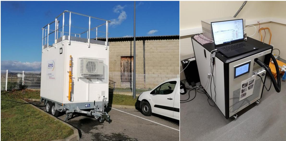
Figure 2 : Photos de la remorque installée à Arance et du PTR-ToFMS
