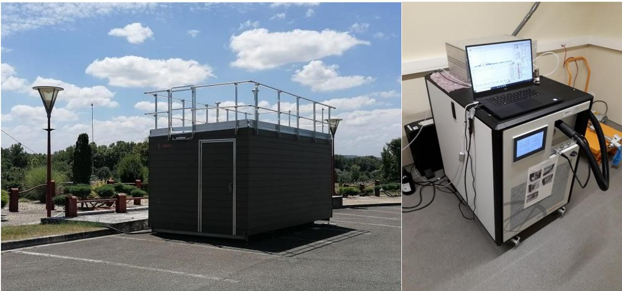
Figure 2 : Photo de la station de Lacq et du PTR-ToFMS
