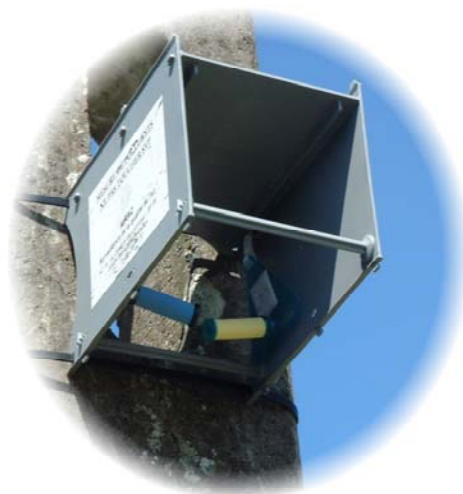
Les échantillonneurs passifs sont placés, durant la mesures, à l'intérieur d'une boîte de protection.
