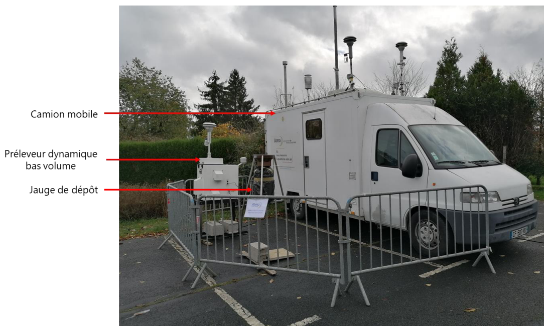
Figure 7 : installation des moyens de mesure
