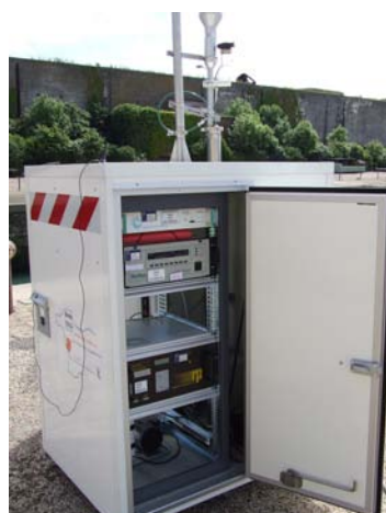
Analyseur de particules TEOM dans une unité mobile
