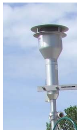
Tête de coupure PM_{10} (à gauche) sans coupure (à droite) de l'analyseur TEOM
