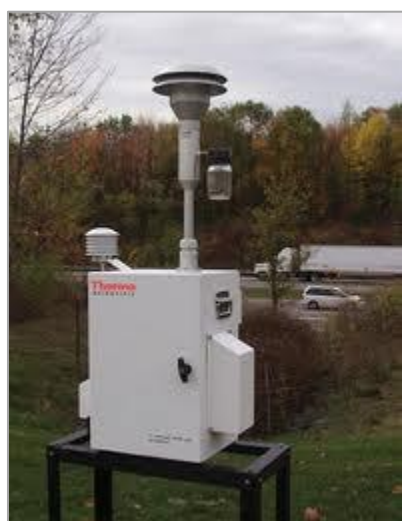
Illustration 1.4 : Préleveurs dynamique à bas débit en situation
