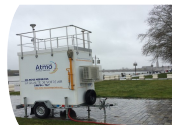
Cabine de mesure mobile installée sur les quais de Bordeaux
