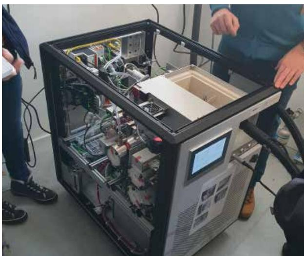
En 2019, Atmo Nouvelle-Aquitaine s'est équipé d'un spectromètre de masse PTRMS. Ce nouvel appareil servira à identifier les composés organiques volatils (COV) et mesurer leur concentration en temps réel.
