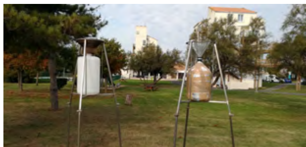
Atmo Nouvelle-Aquitaine utilise des jauges Owen pour mesurer les retombées atmosphériques autour des usines d'incinération des déchets.
