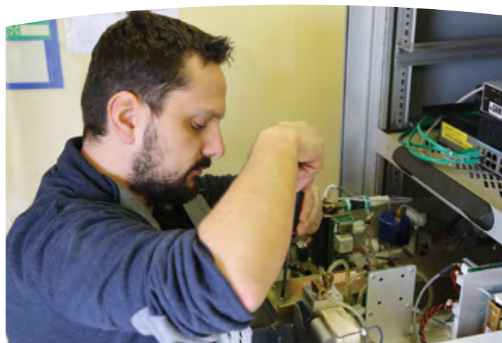
Laurent Vergnolle, technicien d'exploitation du réseau de mesure, réalise la maintenance d'un analyseur de pollution.
