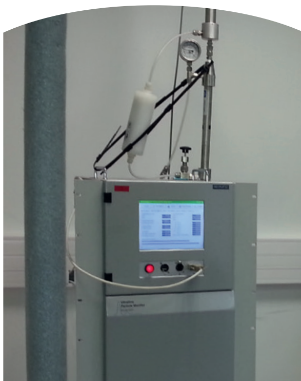
Atmo Nouvelle-Aquitaine utilise deux granulomètres pour étudier les particules ultrafines (PUF).
