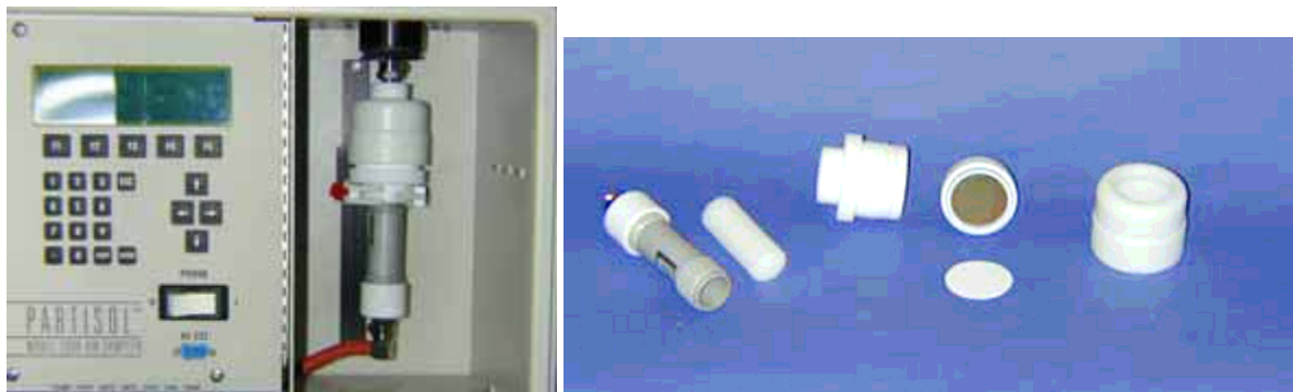
Figure 4 : Module d'échantillonnage assemblé dans le préleveur et ses différents éléments (photo INERIS – LCSQA)
