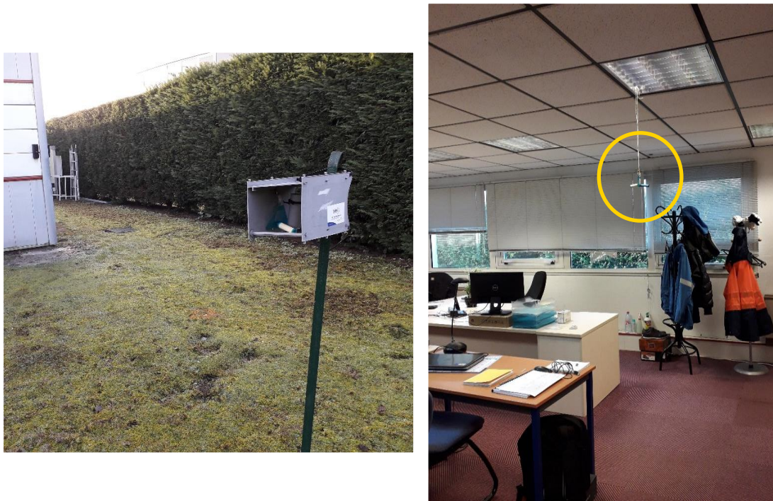
Figure 2 : tubes passifs sur site
