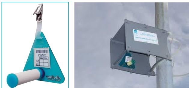
Tube passif Radiello (à gauche) et boîte de protection contre les intempéries (à droite)
