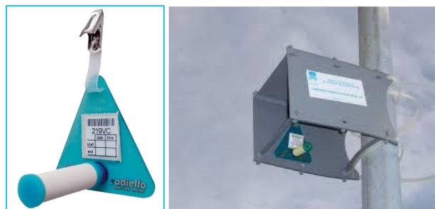
Figure 5 : tube passif Radiello (à gauche) et boîte de protection contre les intempéries (à droite)
